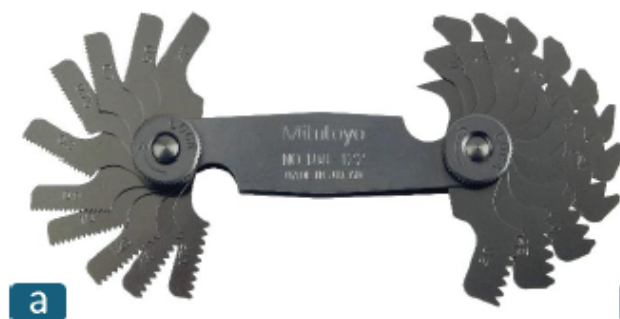
4.20 pav. Žingsniamačio plokštelės: a) plokštelių rinkinys (Mitutoyo America Corporation) ir b) sriegio žingsnio matavimas uždedamuoju žingsniamačiu (World Wide Metric, Inc.)
