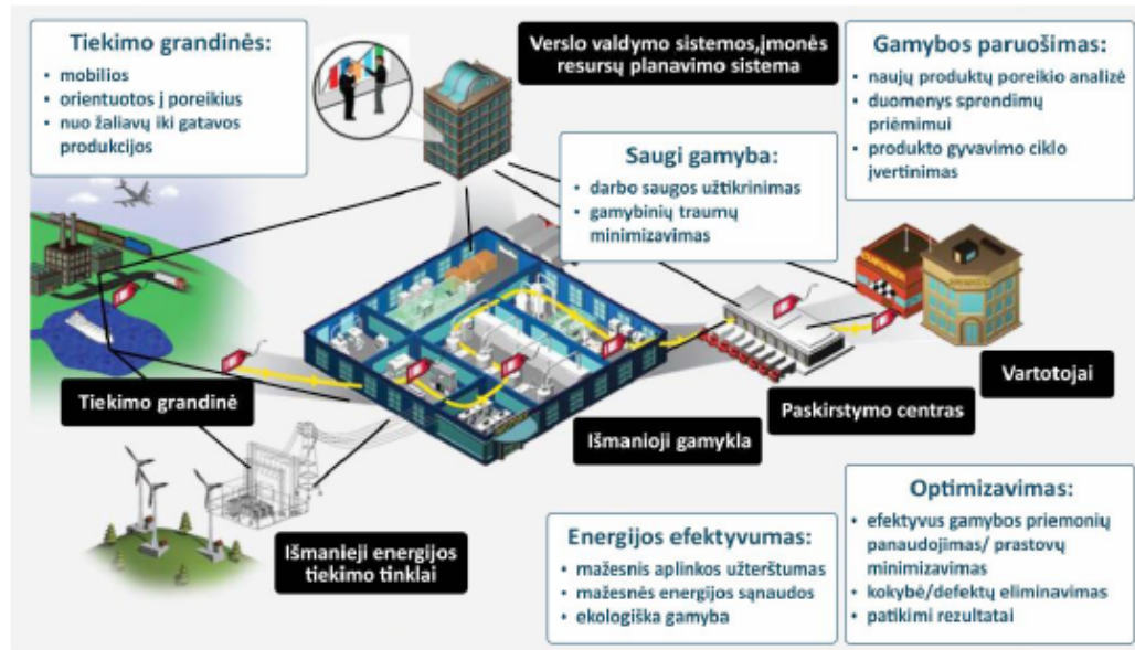
9.5 pav. Išmaniosios gamybos struktūrinė schema (SmartAmerica Challenge)
